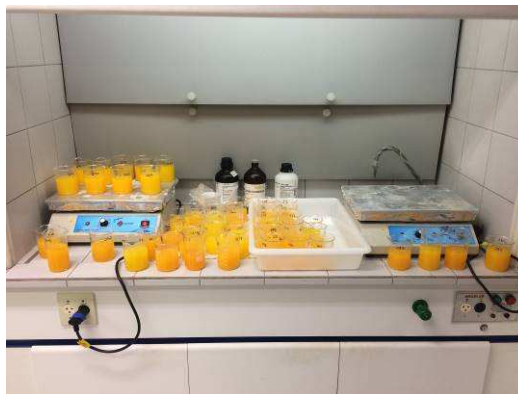
FIGURA 33 - Amostras em béqueres de 250 mL em repouso após processo de precipitação do \text{PbCrO}_4 pela adição de cromato de sódio às soluções aquecidas à ebulição.
