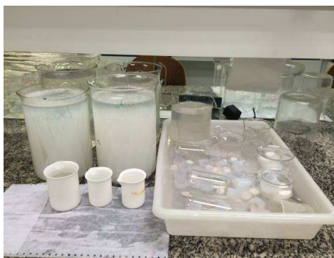
FIGURA 14 - Processo de descontaminação dos materiais com \text{HNO}_3 , Extran e água destilada.
