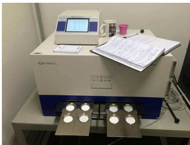
FIGURA 39 - Detector proporcional de fluxo gasoso de baixa radiação de fundo, modelo Berthold LB 770 2/5 para contagem de atividades \alpha e \beta .
