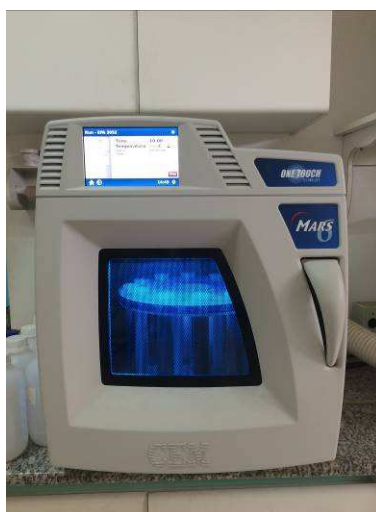
FIGURA 17 - Microondas MARS-6 utilizado para a abertura total das amostras de sedimentos
