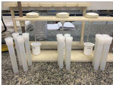
FIGURA 18 - Filtração das amostras de sedimento para béqueres de teflon, após processo de abertura total em microondas por meio do ataque ácido com HCl, HF e HNO 3
