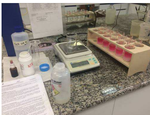
FIGURA 23 - Etapa de adição de NTA, água ultra-pura e gotas de vermelho de metila às amostras.
