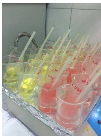
FIGURA 25 - Segunda precipitação do método a partir da adição de sulfato de amônio e ácido acético glacial – chumbo (Pb) permanece complexado ao NTA da solução – indo da cor amarela translúcida à cor rosa turva.
