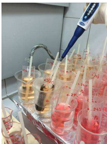
FIGURA 30 - Precipitação de sulfeto de chumbo de cor preta com a adição de sulfeto de sódio.
