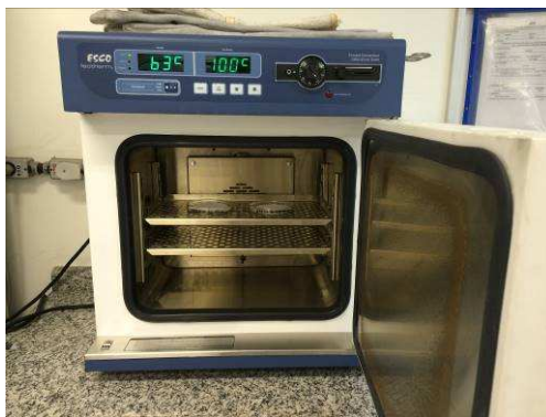
FIGURA 15 – Estufa para secagem das amostras de sedimentos, mantidas até constância da massa
