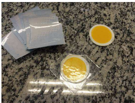
FIGURA 36 – Papéis de filtro de fibra de vidro com precipitado de \text{PbCrO}_4 sendo cobertos com filme plástico.
