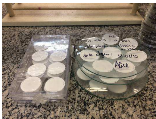
FIGURA 27 - Filtros com precipitado branco de Ba(Ra)SO_4 esperando o tempo de 21 dias para contagem no detector proporcional de fluxo gasoso.
