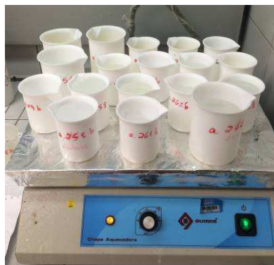
FIGURA 19 - Amostras em béqueres de teflon (eliminando o ataque do HF) em chapa aquecedora para evaporação até secura.
