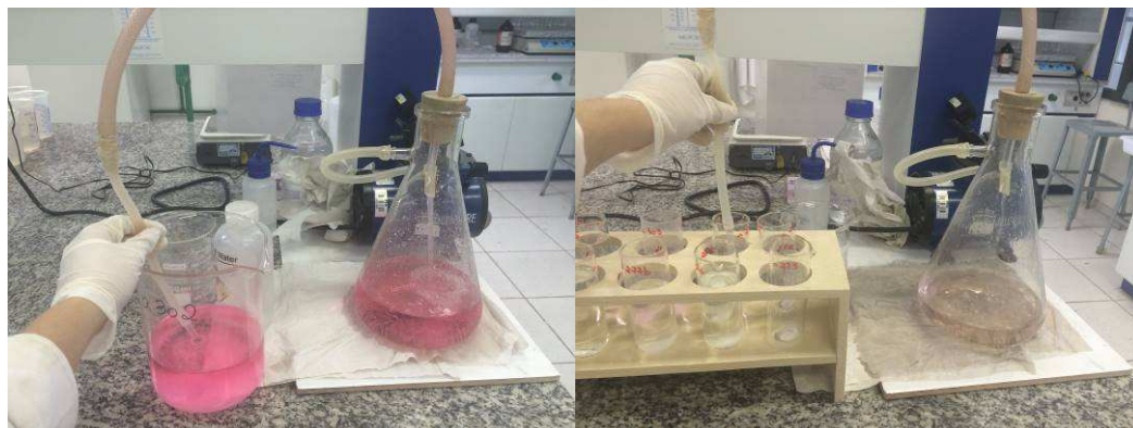
FIGURA 22 - Descarte do sobrenadante com auxílio de uma bomba a vácuo, tanto nos béqueres de 2 L de capacidade quanto nos tubos de centrífuga após lavagem do precipitado.
