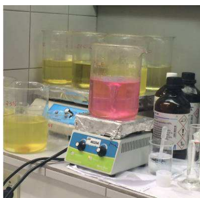
FIGURA 21 - Primeira precipitação do método de separação radioquímica realizada após amostra atingir temperatura de ebulição e a adição de \text{H}_2\text{SO}_4 3 M.
