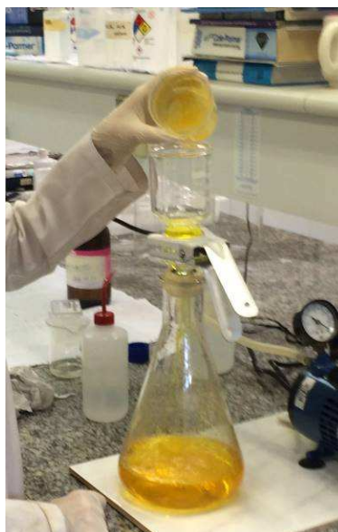
FIGURA 34 – Filtração a vácuo em funil Millipore do precipitado de \text{PbCrO}_4 para papel de filtro de fibra de vidro.
