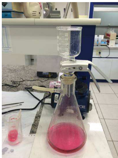
FIGURA 26 - Filtração a vácuo em funil Millipore para papel de filtro de fibra de vidro do precipitado de Ba(Ra)SO_4 .
