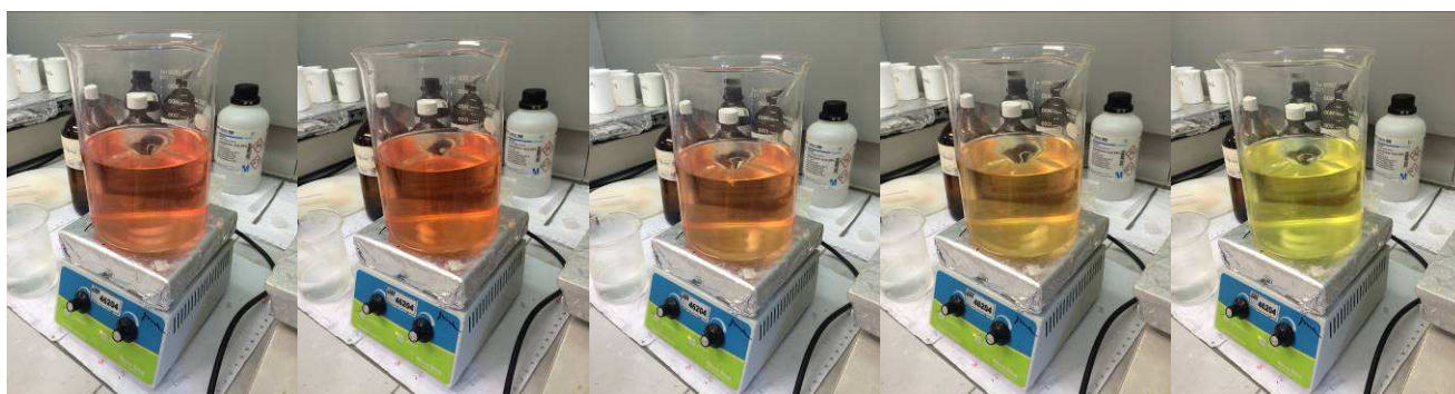
FIGURA 20 - Viragem do indicador de vermelho para amarelo pela adição de \text{NH}_4\text{OH} p.a.
